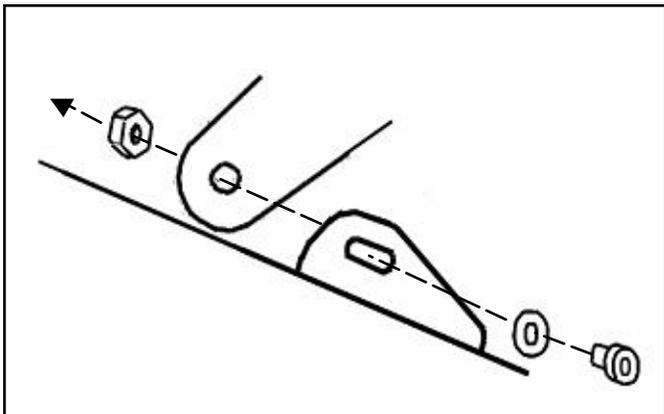
サイレンサーをテールパイプに差込み、スプリングを掛けます。次にボルト・ワッシャー・ナットを用いてサイレンサーをサイレンサーステーに固定します(仮留め)。テールパイプやサイレンサーと、車体・カウル等に干渉が無い事を確認し、問題がある場合は各差込み部で微調整を行った上で、クランプバンドやボルトナット類を本締めします。最後に、純正マフラー脱着の際に取り外した部品があれば、それらを取り付けます。
