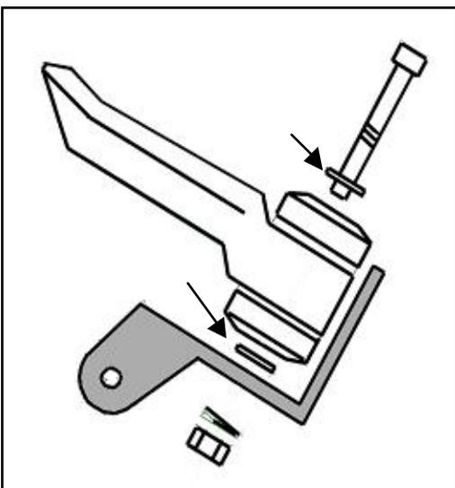
純正のタンデムステップバーを固定しているピンを取り外し、附属の ボルト・ナット・ワッシャー・スプリングワッシャーを用いて サイレンサーステーを共締めします。
